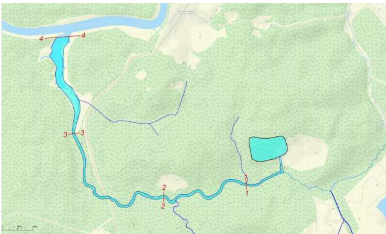
Рисунок 6.3 – Зона затопления при реализации сценария аварии А2
