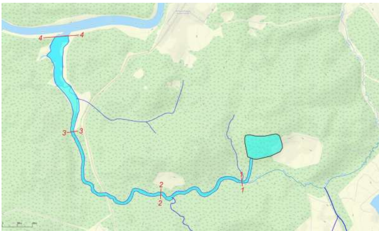
Рисунок 6.2 – Зона затопления при реализации сценария аварии А1
