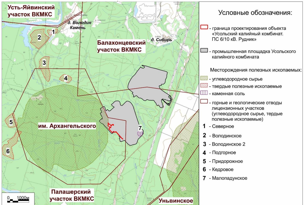
Рисунок 5.4 – Карта-схема месторождений полезных ископаемых и границ горных отводов в районе размещения объекта проектирования
