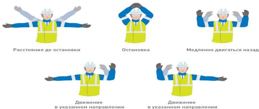
Рисунок 1 - Общепринятые сигналы при движении задним ходом, подаваемые сигнальщиком
